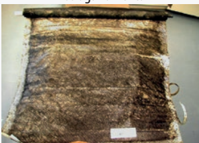
Zaprljana membrana usled nepravilnog tretmana (odmotana)
