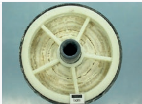
Membrana zaprljana taloženjem naslaga kamenca
