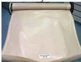
Čista membrana iz membranskog elementa (odmotana)
